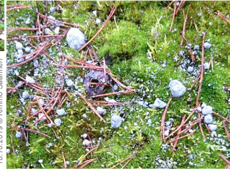
▲► Suuremman klinkkeriannoksen koeala Mäntylänmäen lakikallion eteläreunalla. Raekoko vaihteli liiki pölymäisestä isoihin ”sementtimurikoihin”.
